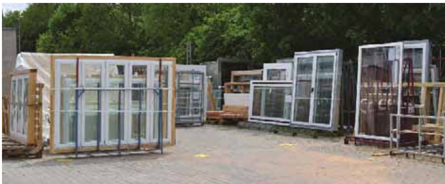
Bild 8. Fenster zur Prüfung in starrem Stahl- oder Holzrahmen montiert
