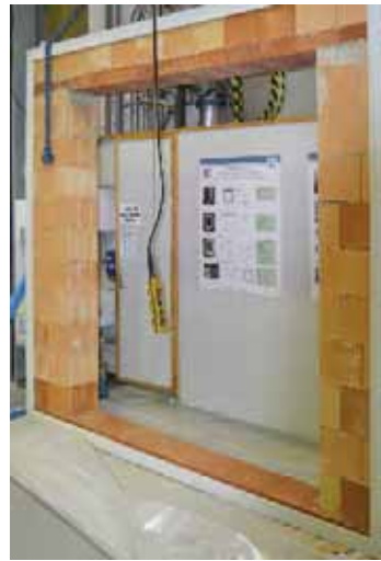
Bild 24. Rohbauöffnung in der „Versuchswand“ mit zusätzlichem Ziegelsturz an der Unterseite
