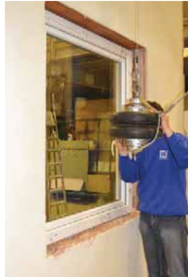
Bild 72. Dynamischer Versuch in der Klasse RC 2 mit einem Doppelreifenpendel (50 kg) [35]
