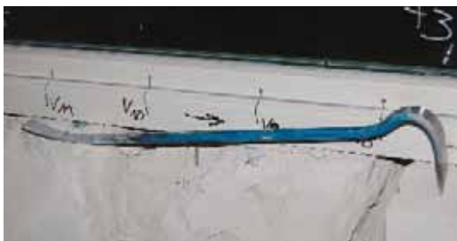
Bild 68. Versuch, mit dem Kuhfuß innerhalb von fünf Minuten direkt durch die 36,5 cm dicke Wand zu brechen [30]
