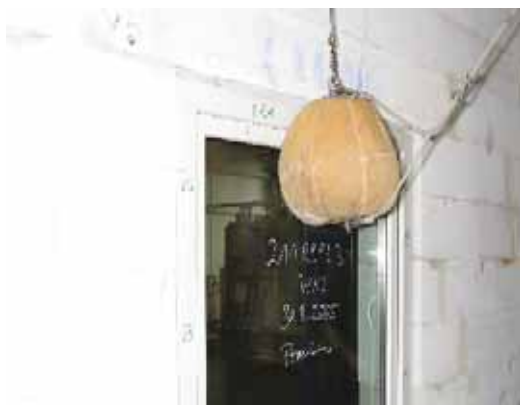
Bild 58. Dynamischer Versuch mit einem Sandsack (30 kg) [34]
