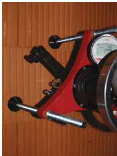
Bild 11. Prüfgerät zur Prüfung eines Kunststoffdübels mit Ringöschenschraube direkt am Bauwerk
