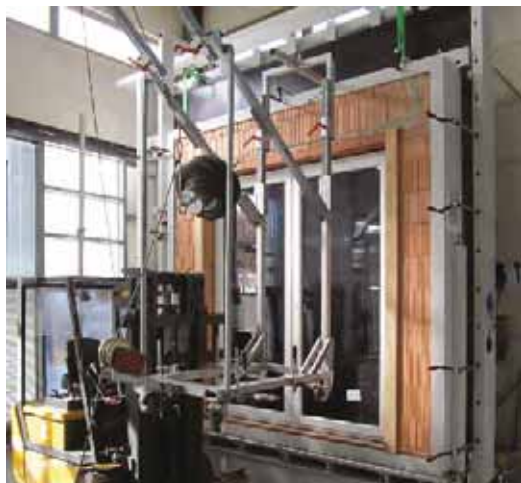
Bild 43. Simulation einer unplanmäßigen Nutzung mit einem Doppelreifenpendel [15]
