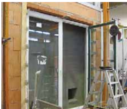
Bild 33. Versuch zur Überprüfung der Verformung bei statischer Zusatzlast am Fensterflügel [15]
