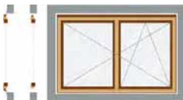
Bild 4. Fenster in Fassadenöffnung bzw. vor der Fassade [4]
