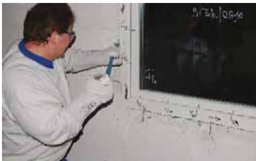
Bild 67. Manuelle Einbruchprüfung mit dem ca. 700 mm langen Kuhfuß [30]
