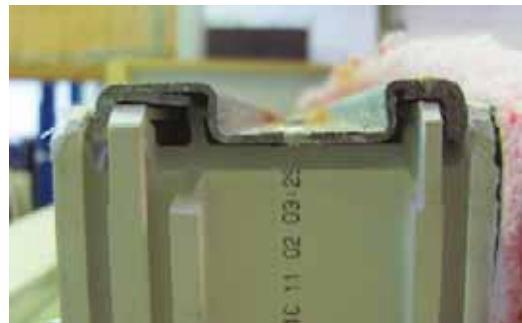
Bild 26. Oberseitige Verstärkung des Fensterprofils mit zusätzlichem Stahlprofil [15]
